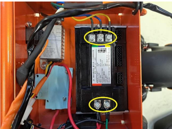
Irrota moottorin vaihejohtojen ja päävirtajohtojen kiinnitysruuvit ohjainlaitteesta (ristipäämeisseli ph2).
