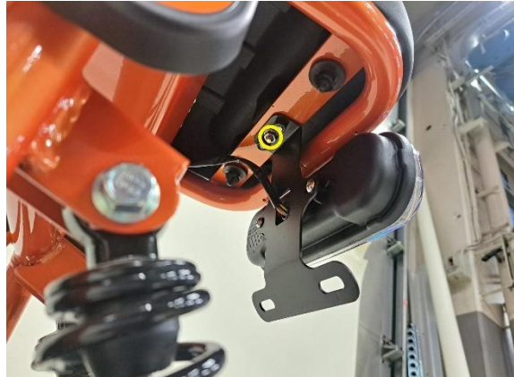
Irrota istuimen kiinnitysmutteri (kiintoavain 10 mm).
